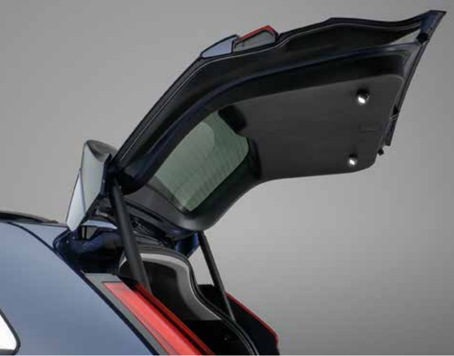
BELYSNING FÖR BAKLUCKAN Belysningen av bakluckan har utvecklats för att öka komforten och säkerheten genom att inte bara lysa upp bagagerummet utan även området bakom bilen. LED-lamporna som sitter på bakluckans insida ger ett starkt och jämnt fördelat ljus i bagagerummet, även när det är fullastat.
