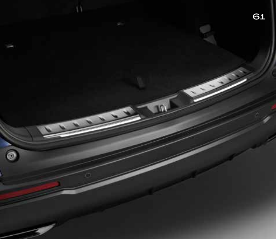
BELYSTA LISTER FÖR BAGAGETRÖSKEL Skydda bagagetröskeln genom att montera den här rostfria listen på bagagetröskeln. Den har belysning som tänds när du öppnar bakluckan för bättre synlighet på natten.
