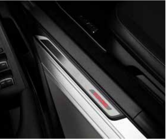
INTEGSLISTER MED RÖD BELYSNING De belysta instegslisterna är tillverkade av borstat rostfritt stål och har en upplyst röd Civic-logotyp. De skyddar dörrtrösklarna mot märken och repor. Satsen inkluderar belysta instegslister fram och instegslister utan belysning bak.
