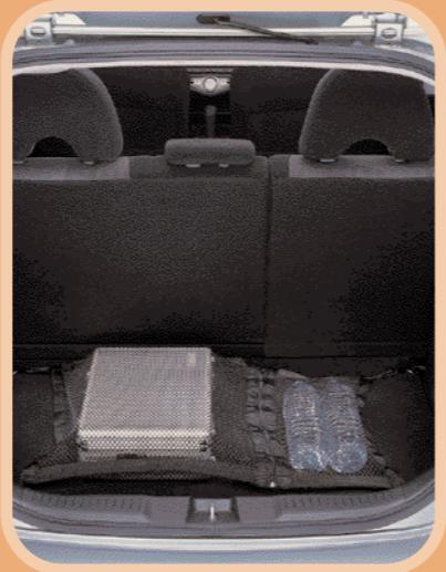
Förvaringsnät – kan användas som lasträkningsnät, vertikal lastrumsavdelare eller som skydd mot passagerarkupén för att hålla bagaget på plats.
