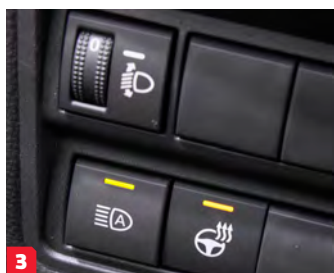
1. Trådlös laddning av mobiltelefon är praktiskt och bekvämt. Opel har framtidssäkrat Corsa med en laddplatta som duger även när telefonen närmar sig A4-storlek. 2. Swift har trummor bak. Klokt beslut på en så lätt bil. 3. Automatiskt helljus och rattvärme i Yaris. Högreglering av LED-strålkastaren får föraren göra. 4. "Magic seats". Med baksätets sittdyna uppfälld är det inga problem att transportera vare sig utemöbler eller konbanans osjunga hjältar stående.
