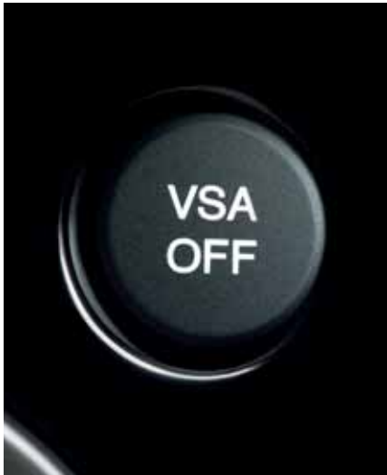
VSA Stabiliseringssystemet VSA hjälper till att hålla kursen vid kurvtagning, acceleration och undanmanövrar.
