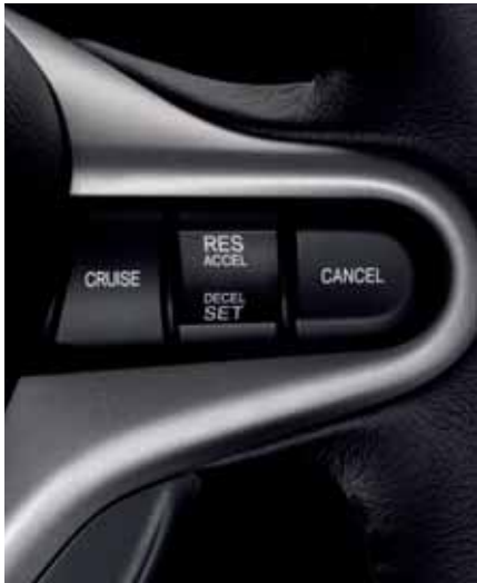
Farthållare På den högra rattekern kan farthållaren ställas in med fingret eller tummen utan att du behöver släppa ratten. (Ej Comfort)
