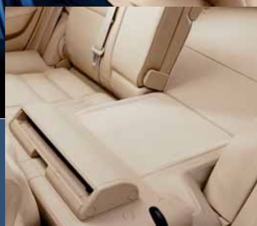
Sitsarna fälls upp när du trycker ned ryggstödet. Baksätets ryggstöd bildar ett plant golv, nackskydden får plats under det.
