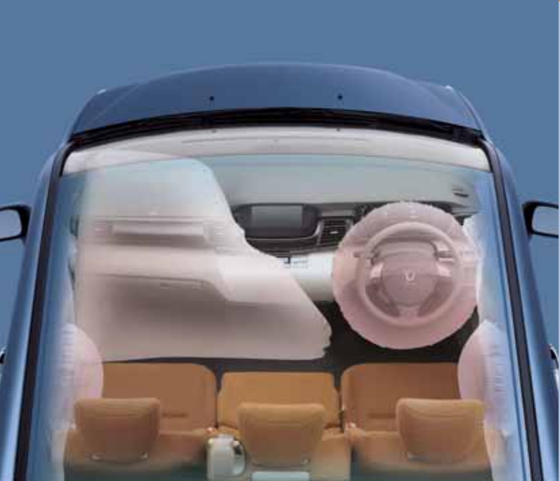
På framsätets passagerarsida finns en krockkudde med större kapacitet för att kunna skydda två passagerare.
