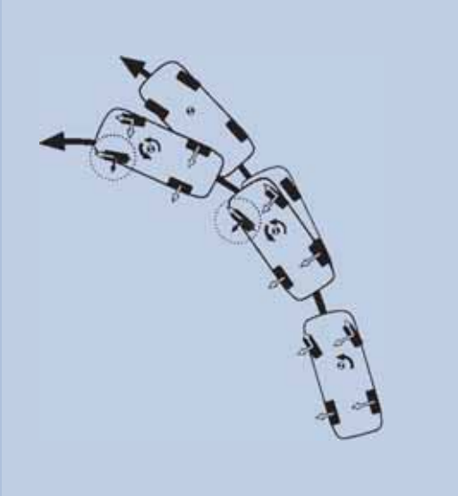
VSA kontrollerar understyrning
