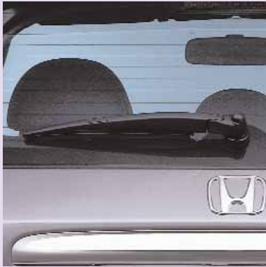
Bakrutetorkare – Om vindrutetorkarna är på startar bakrutetorkaren automatiskt när du lägger i backen
